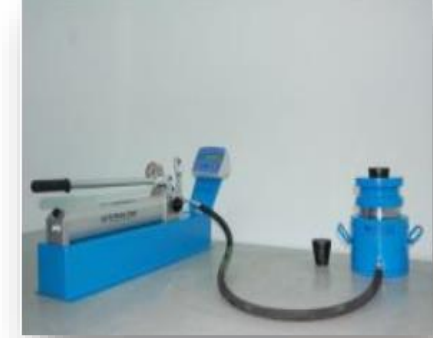
Dijital Bulon (Ankraj) Çekme Cihazı
