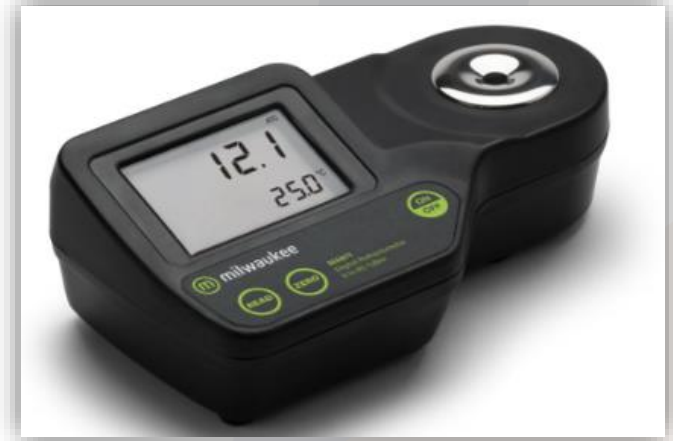
Dijital Refraktometre Milwaukee MA871
