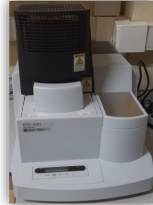
Termogravimetrik Analiz Cihazı (TGA/DTA) Shimadzu DTG 60 H
